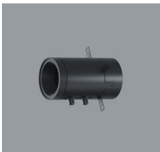
AC002124 Lens Unit framing Aluminium/Kunststoff, schwarz lackiert, 360° drehbar. Werkzeuglos wechselbar. 2 Projektionslinsen, stufenlos fokus- sierbar. Konturenschieber: Edelstahl, schwarz. Aperturblende.
